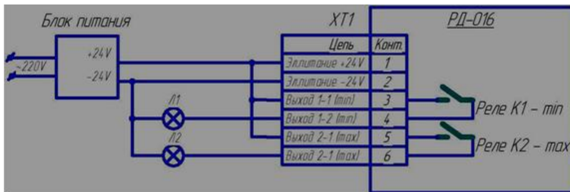
Рис. 4. Схема проверки работоспособности реле РД-016.
